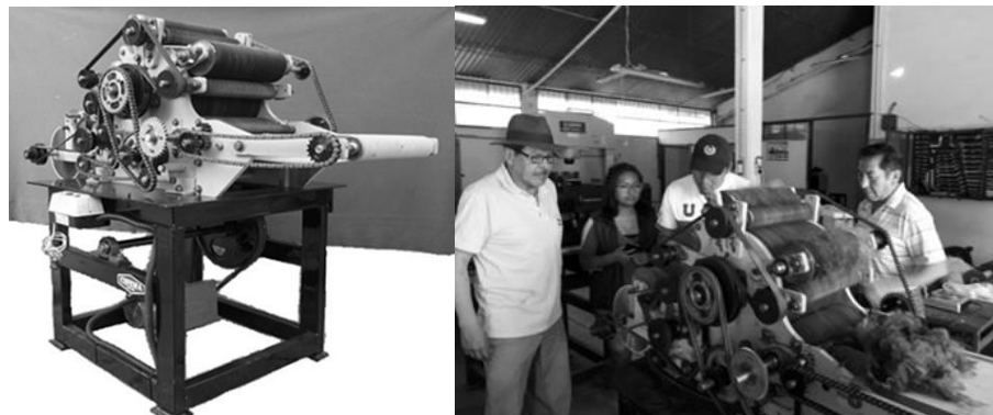
Figura 1. Izquierda: Cardadora artesana; Derecha: Cardadora innovada en funcionamiento ( Left: Semi industrial carder; Right: Innovative carder functioning ).
